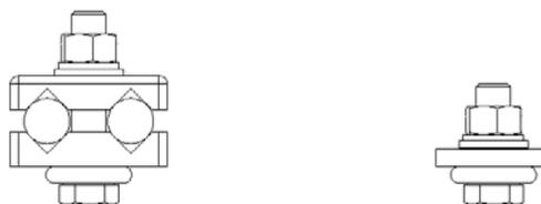
Р и с у н о к 7.3 – Способ подключения ошиновки при помощи плашечных зажимов и стандартных шин
